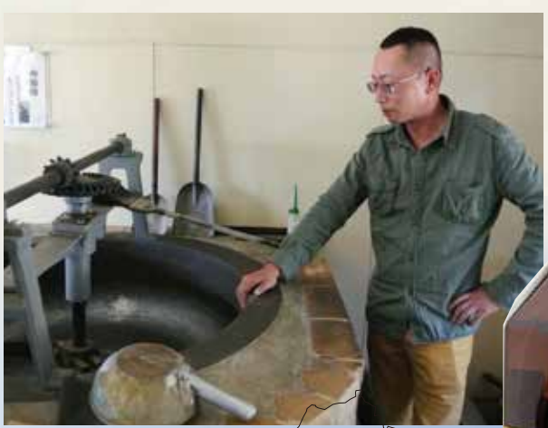
(上) 菜種を煎る、ほうろく釜。創業者の大嶽氏が創案、設計したもの。 (左) 菜種は愛知県産。遺伝子組み換えでない菜種です。 (左) 油を搾るのに相応しい菜種だけを、これで選別します。
