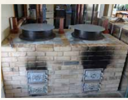
(右上) 先代、大嶽氏の、菜種油の搾油風景。 (右下) 油を搾った後、静置し自重だけで沈殿・濾過します。 (左) 加熱用釜。油は、熱を通すとサラリとなめらかになります。
