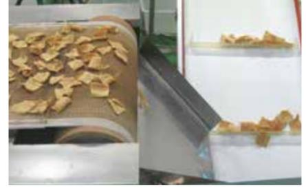
ベルトコンベアーで移送されながら、さらに乾燥、自然冷却され、完成です。
